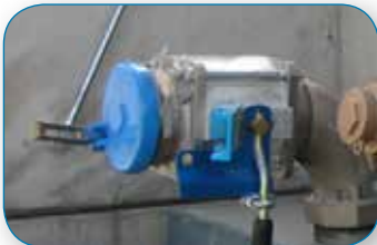
Pražnjenje između dva nevezana provodljiva predmeta.
