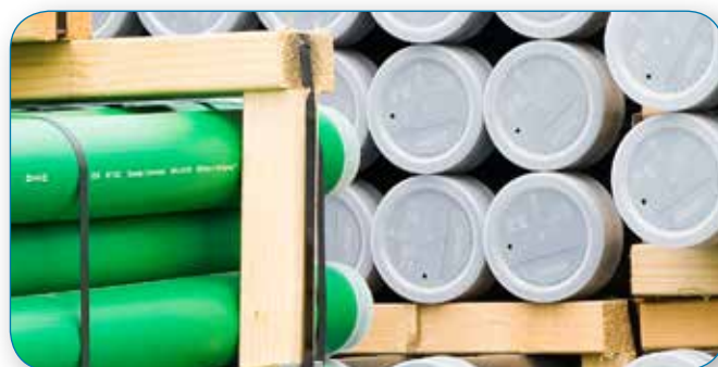
Les bouchons d'extrémité doivent être laissés sur les tuyaux jusqu'à l'installation afin de protéger ces derniers des contaminations et de la poussière.
