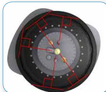
S'assurer que les tuyaux forment un angle droit par rapport à la paroi de la chambre et aux raccords sur le plateau.
