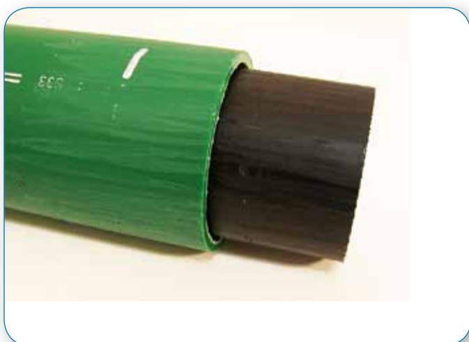
Grattage insuffisant. Toutes les zones n'ont pas été grattées.
