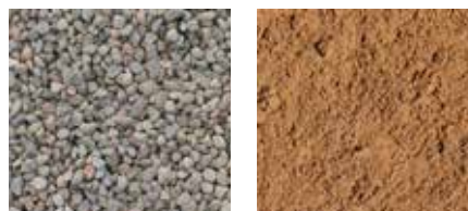
De gauche à droite : gravillon roulé et sable.
