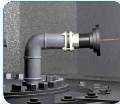
Placer le pointeur laser dans les raccords prémontés, sur le plateau de trou d'homme.
